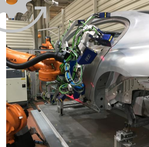
FFTplace BestFit Korrektur z.B. durch Roboter
