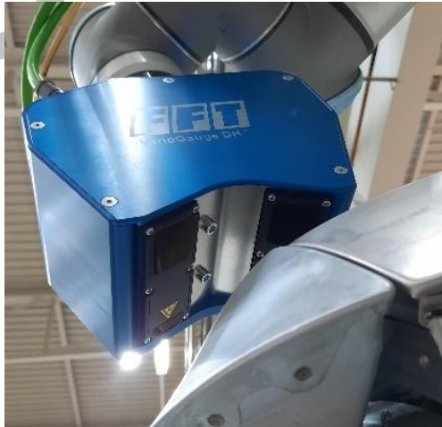
Abweichungen messen (mit dem Messroboter)
